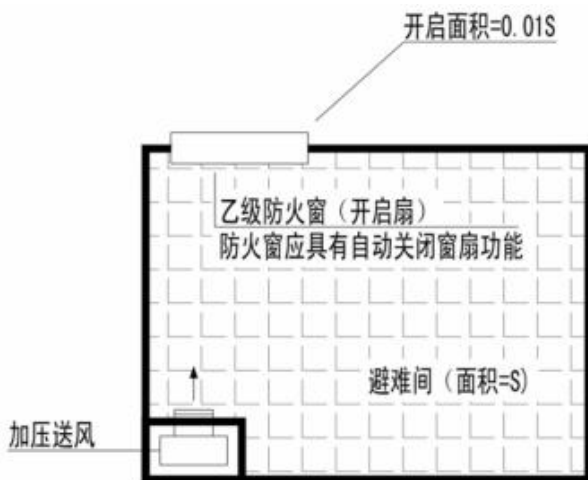
图 1.22 避难层（间）防火窗设置示意图
